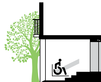
Instalación de una plataforma salva-escalera
