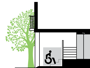
Instalación de una plataforma elevadora
